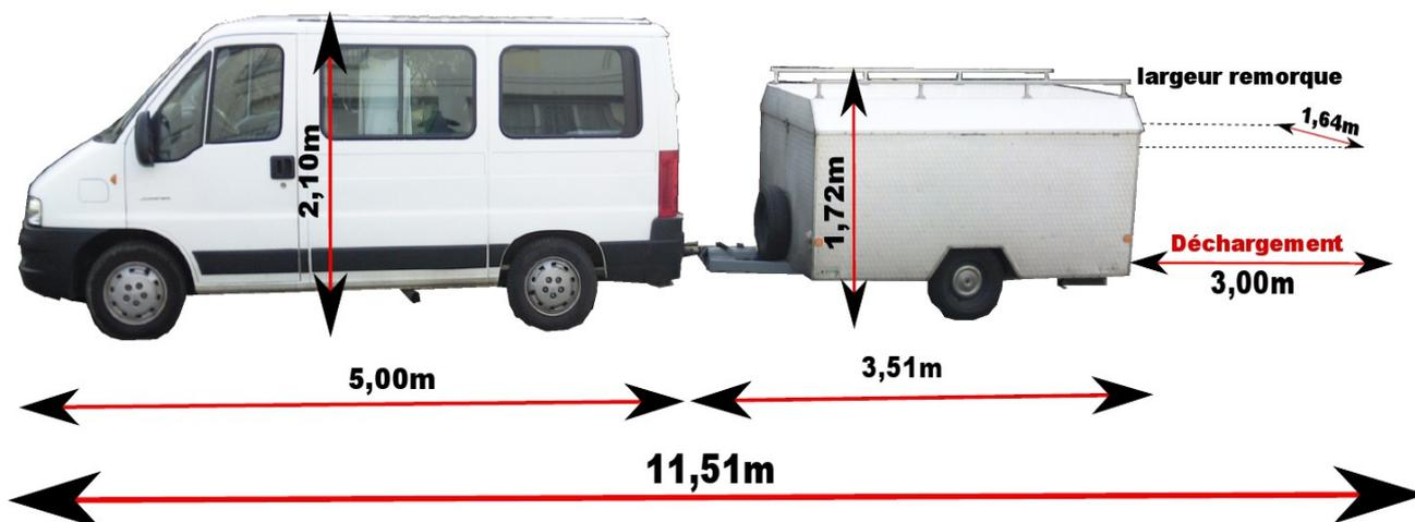
**3 places de parking dans la longueur est nécessaire pour l'ensemble des véhicules (déchargement par l'arrière de la remorque)**
